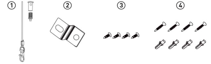
1. Desenrosque el tornillo del panel y después fije el soporte en el orificio roscado usando los tornillos cortos suministrados. **IMPORTANTE:** Para los paneles -E1, utilice los tornillos suministrados en el paquete de accesorios. Para paneles -01, reutilice los tornillos retirados y no los del paquete de accesorios.
